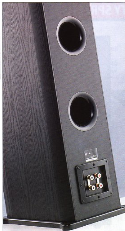
Dwa porty BR sugerują zastosowanie niezależnych komór akustycznych, ale tak nie jest – komora dla obu wooferów jest wspólna
